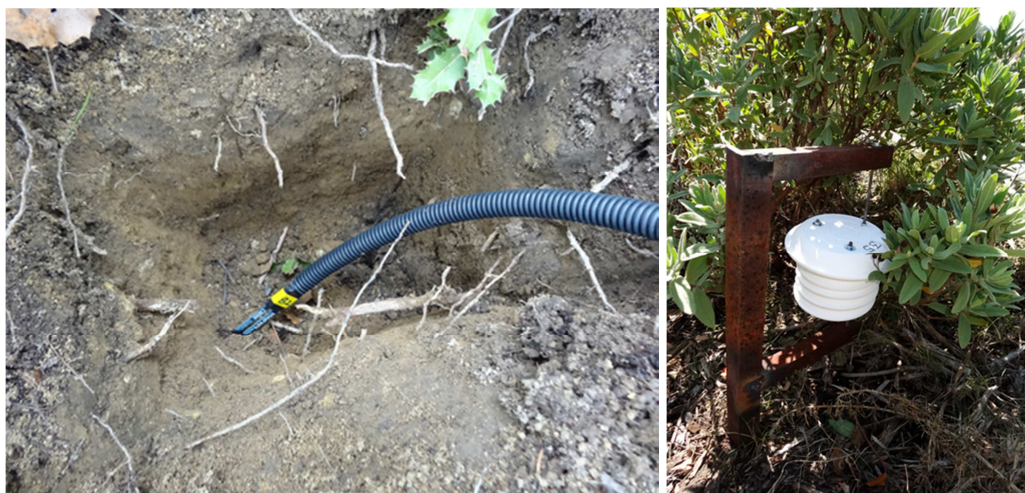
Photos 17. Capteur d'humidité du sol (sonde Decagon, à gauche) et abri pour capteur de température et humidité de l'air (droite).
