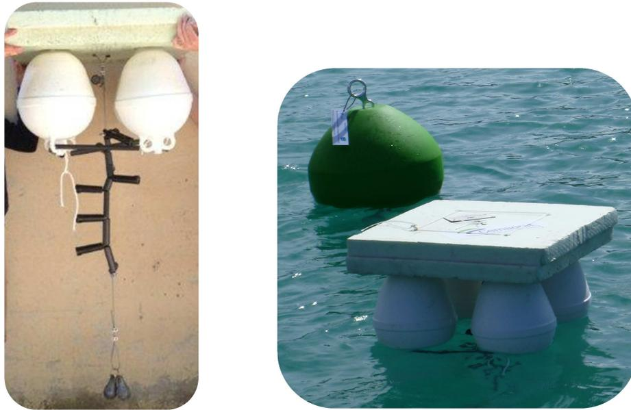
**Figure 2 : Photographies, ex situ à gauche et in situ à droite, du dispositif de suivi en continue du gradient thermique de sub-surface, *i.e.* entre la surface et 55 cm de profondeur. De plus, un thermomètre a été positionné hors de l'eau pour enregistrer la température de l'air à environ 30 centimètres de la surface de l'eau.**
