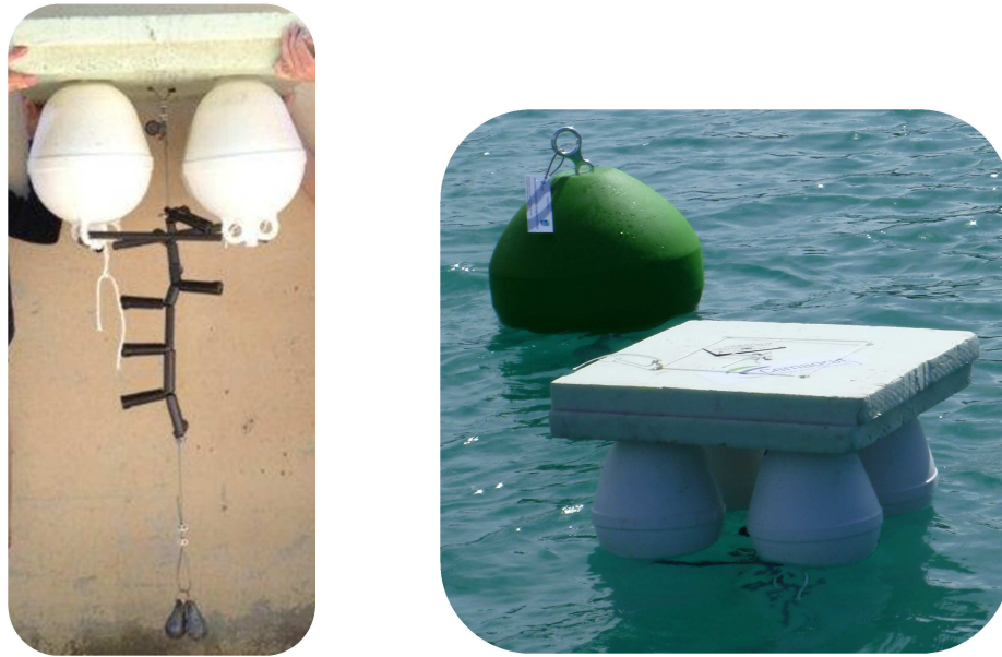
Figure 2 : Photographies, ex situ à gauche et in situ à droite, du dispositif de suivi en continue du gradient thermique de sub-surface, i.e. entre la surface et 55 cm de profondeur. De plus, un thermomètre a été positionné hors de l'eau pour enregistrer la température de l'air à environ 30 centimètres de la surface de l'eau.
