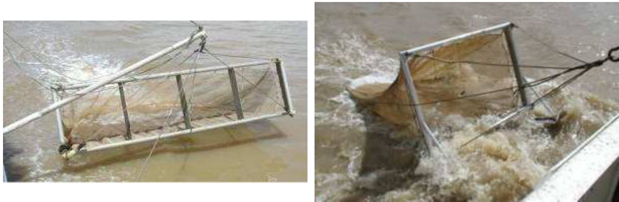
Figure 10. Vues du cadre d'échantillonnage de surface bâbord avant son immersion (à gauche) et du cadre arrière avant son immersion (à droite)
