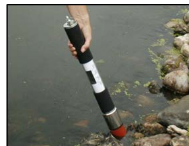
Figure 3: Photographies de la BenthosTorch (source: Manuel d'utilisation)
