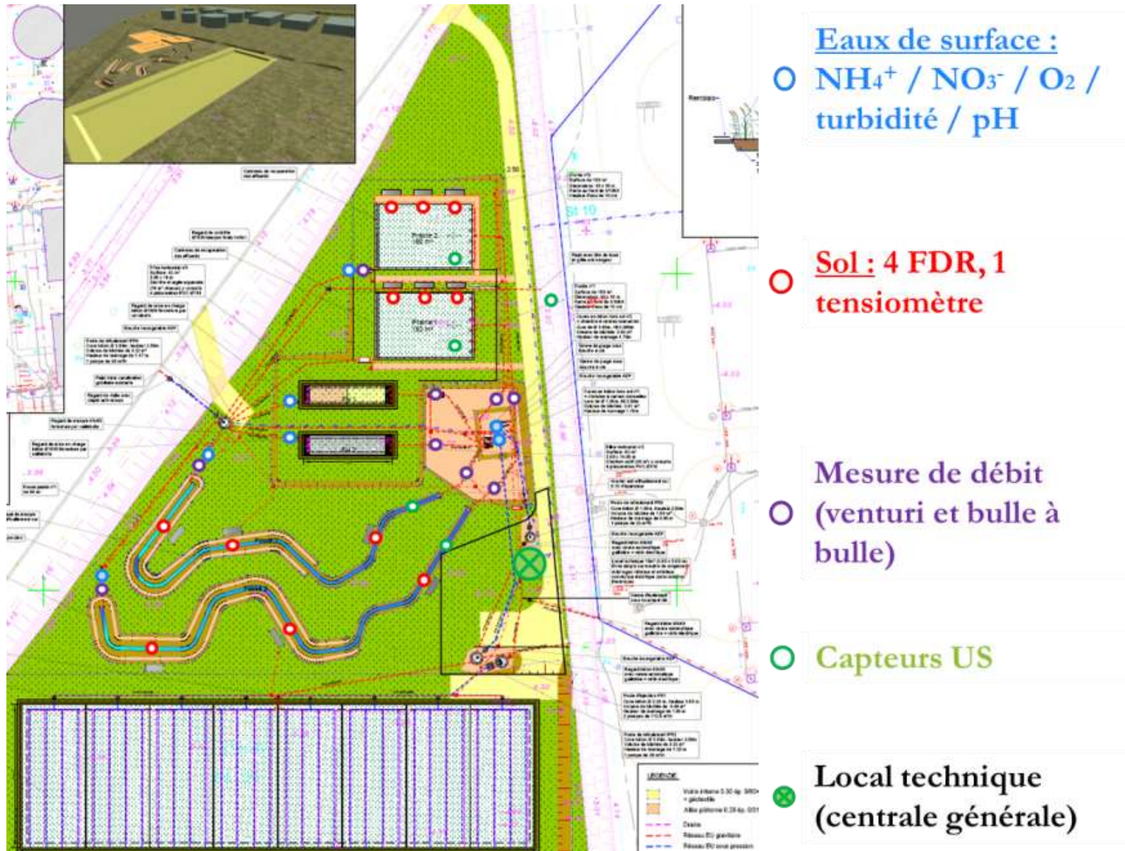
Figure 17 : Schéma de principe et lieu d'implantation des capteurs du site expérimental
