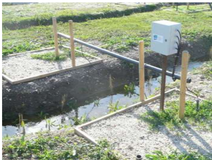
Figure 25 : Photographie du système d'observation du colmatage sur les fossés
