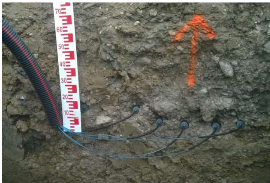
Figure 20 : Photographie de capteurs réflectométriques implantés dans le sol
