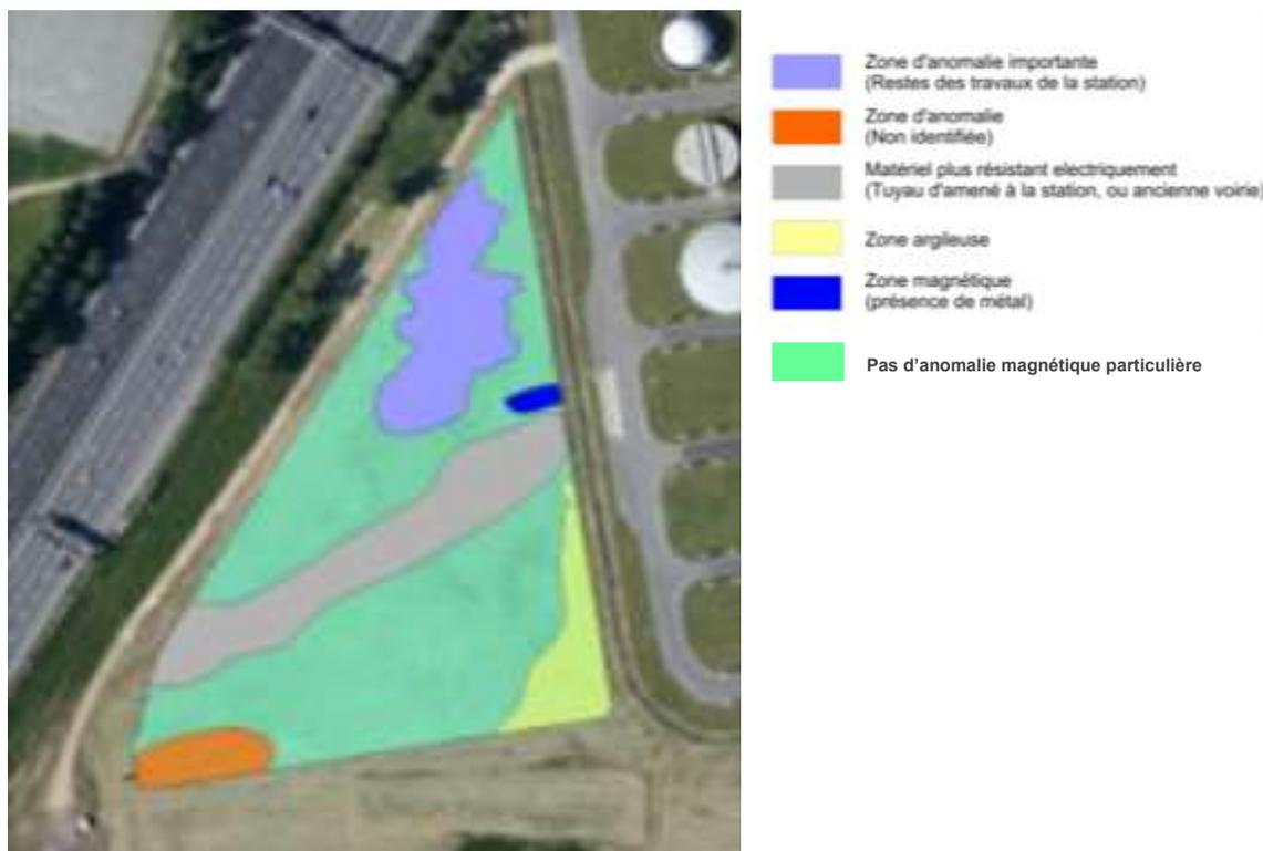
Figure 5 : Synthèse des hétérogénéités du site sur la base d'une prospection électromagnétique
