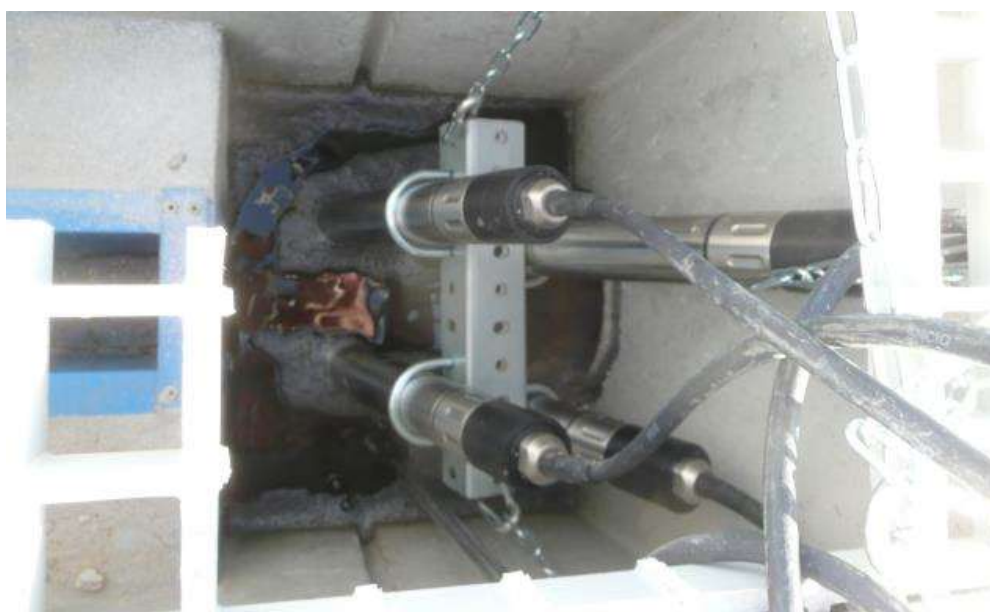
Figure 19 : Photographie d'un point de mesure de la qualité de l'eau de surface (ammonium, nitrates, oxygène dissous, turbidité)
