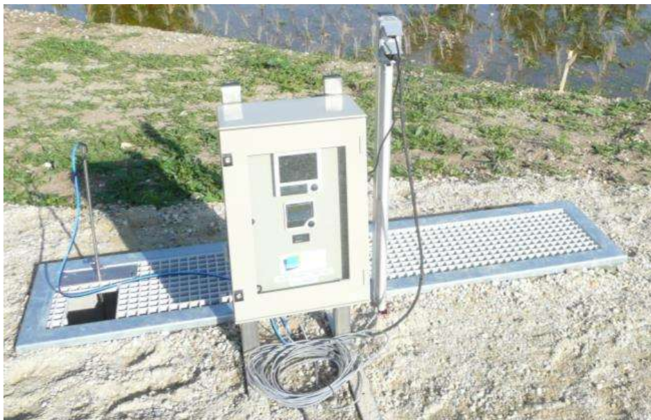
Figure 18 : Photographie d'un point de mesure de débit d'eau de surface (canal de comptage, canne de mesure, armoire contenant le débitmètre bulle à bulle et alimentation électrique)
