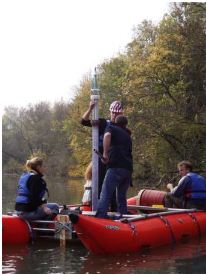
Planche 1 - Réalisation d'une carotte de sédiment
