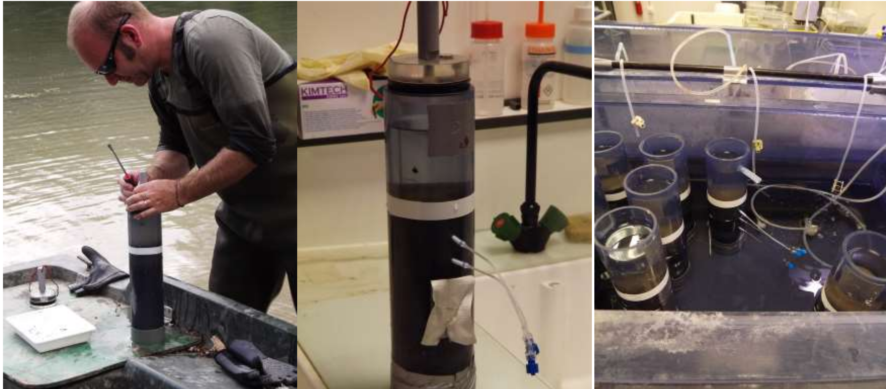
Planche 2 - Exposition des chironomes au sédiment non modifié : réalisation de mini-carottes (gauche) et chambres d'exposition (droite)
