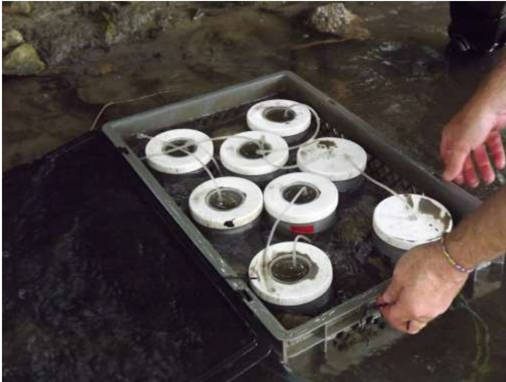
Planche 3 – Dispositifs d'encagement des chironomes (avec tuyaux pour l'ajout de nourriture)
