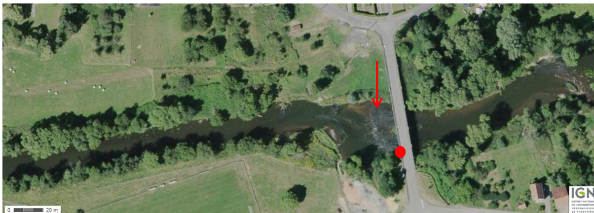
Figure 26: Photo aérienne de la station de Bliesbruck sur la Blies (pont rouge) permettant de voir le radier naturel (la section de contrôle à bas débit, flèche rouge) (source : Géoportail).
