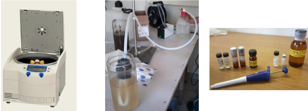
Figure 2 : Photographies des étapes de prétraitement des échantillons de boues sur site, (a) centrifugation et (b) filtration par module de filtration fibre creuse de marque Polymem 0,1 \mu\text{m} , et (c) photographie de l'étape de dopage de la boue du pilote en micropolluants
