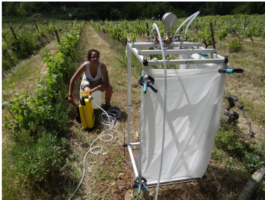
Figure 5-2 : Satuomètre sur parcelle de vigne. La pression du gicleur est contrôlée par un manomètre. Les bâches protègent de l'action du vent sur les gouttes. L'eau est amenée par un asperseur à main.
