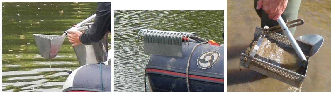
Figure 7 : Matériels d'échantillonnage "fait-maison" (de gauche à droite) : pelle inox triangulaire, pelle râteau avec manche gradué, drague type Cemagref
