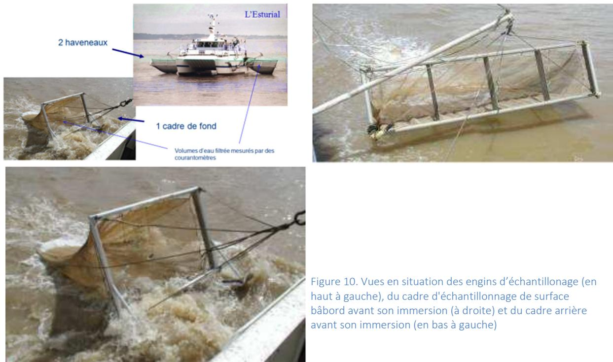
Figure 10. Vues en situation des engins d'échantillonnage (en haut à gauche), du cadre d'échantillonnage de surface bâbord avant son immersion (à droite) et du cadre arrière avant son immersion (en bas à gauche)
