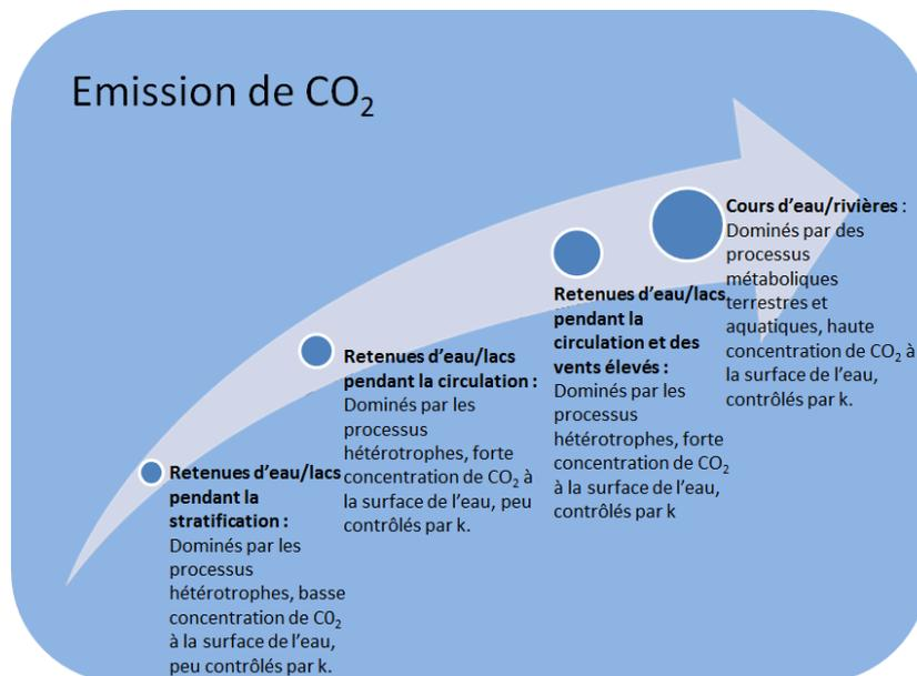
Figure 44 : Présentation schématique de l'effet de différents mécanismes de régulation sur les émissions de CO<sub>2</sub> (par unité de surface) des rivières et lacs peu ventés.  $k$  est la vitesse de transfert du gaz. Le flux de CO<sub>2</sub> est égal à la différence des concentrations de CO<sub>2</sub> dans l'eau et dans l'air, multiplié par  $k$  :  $FCO_2 = (CO_2 \text{ water} - CO_2 \text{ air}) \times k$ . Halbedel 2013
