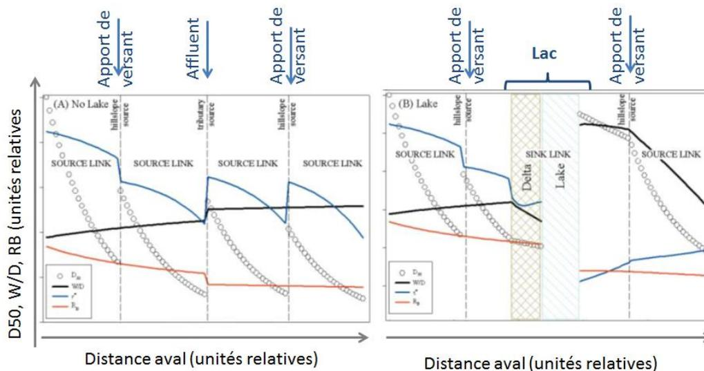
Figure 16 : Evolution hydromorphologique le long d'un cours d'eau selon qu'il comporte (B) ou pas (A) un lac (Arp et al, 2007). D50 est la taille médiane des sédiments du lit,  $W / D$  est le rapport largeur-profondeur du chenal,  $\tau^*$  est la contrainte de cisaillement sans dimension au débit max pour le D50, et RB est le ruissellement max.
