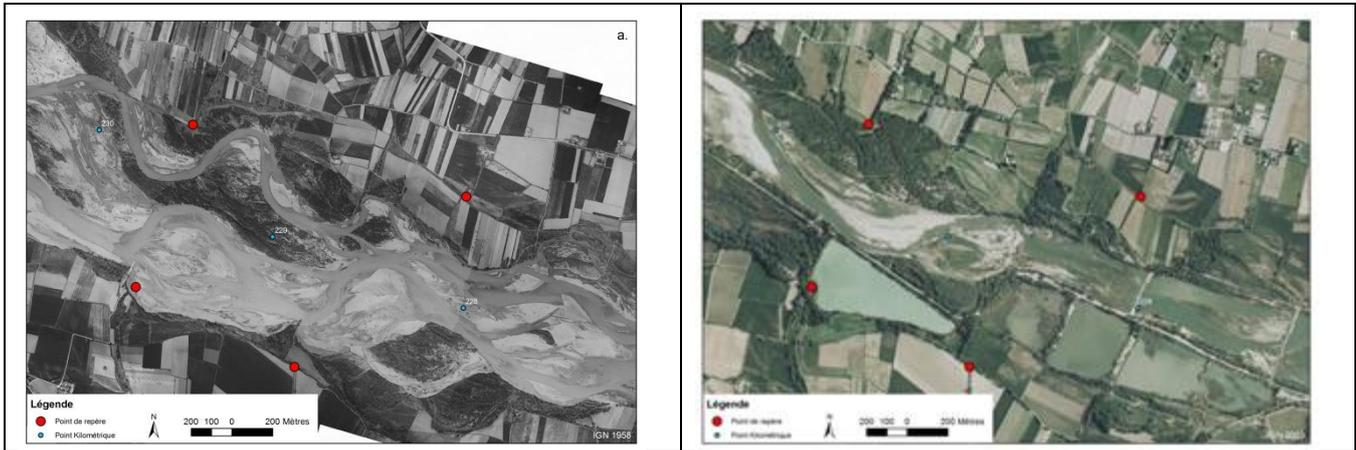
Figure 14 : Evolution du lit de la Durancé entre 1958 et 1998, liée à l'extraction des sédiments et à la construction du barrage de Serre Ponçon. (D'après Chapuis et Collomb 2012)<sup>19</sup>
