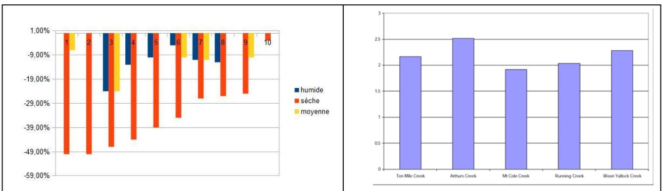
Figure 8 : a) Impacts des retenues sur les débits moyens annuels selon que l'année est sèche, humide ou plutôt moyenne. b) Impact d'un m<sup>3</sup> de retenues agricoles sur les débits : les valeurs supérieures à 1 indiquent qu'une capacité d'1 m<sup>3</sup> de retenue conduit à une réduction des débits de plus de 1m<sup>3</sup>
