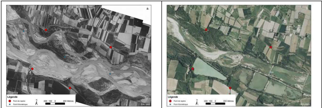
Figure 14 : Evolution du lit de la Durançon entre 1958 et 1998, liée à l'extraction des sédiments et à la construction du barrage de Serre Ponçon. (D'après Chapuis et Collomb 2012) 19
