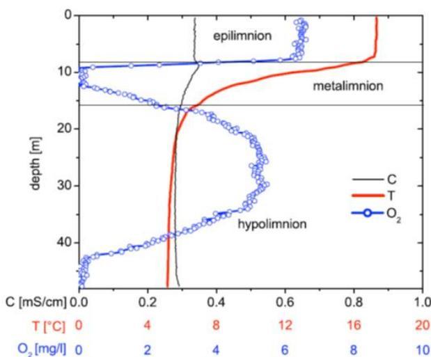
Figure 34 : Profil de température (T), de conductivité (C) et de teneur en oxygène dissous (O<sub>2</sub>) dans le lac Arendsee (Allemagne) le 6 septembre 2000. Boehrer and Schultze 2008
