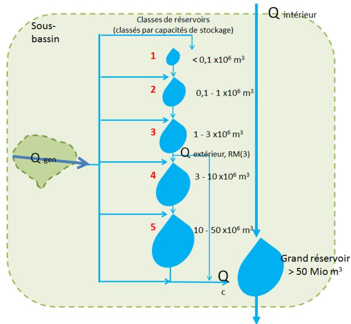
Figure 11 : schéma des réservoirs en cascade du modèle WASA. Chaque réservoir équivalent représente une classe de capacité de retenue. Dans l'exemple présenté, 5 classes sont représentées, de la classe à plus faible capacité (<100000m3) à la classe à plus forte capacité (10-50 millions m3). Le bassin en question est doté à son exutoire d'un grand barrage (LR) dont le fonctionnement hydrologique est explicitement simulé.
