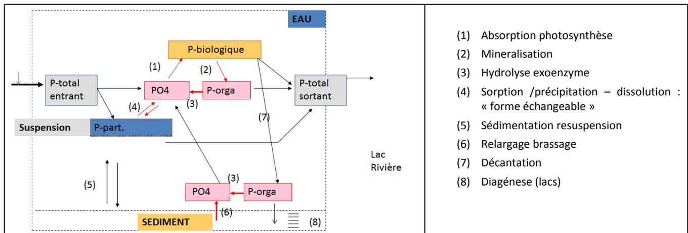
Figure 38 : Cycle du phosphore en milieu aquatique : flux, transports et compartiments. D'après traité de limnologie (Pourriot et Meybeck, 1995), modifié
