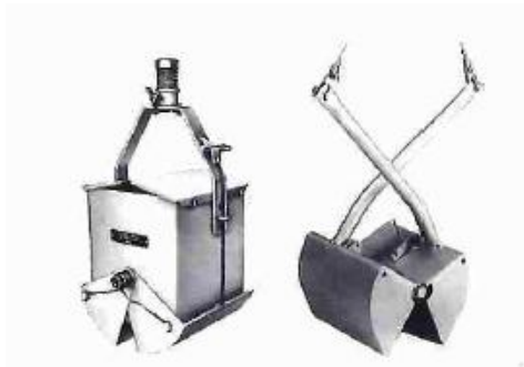
Figure 1 : Benne Eckman (à gauche) et benne Van Veen (à droite)
