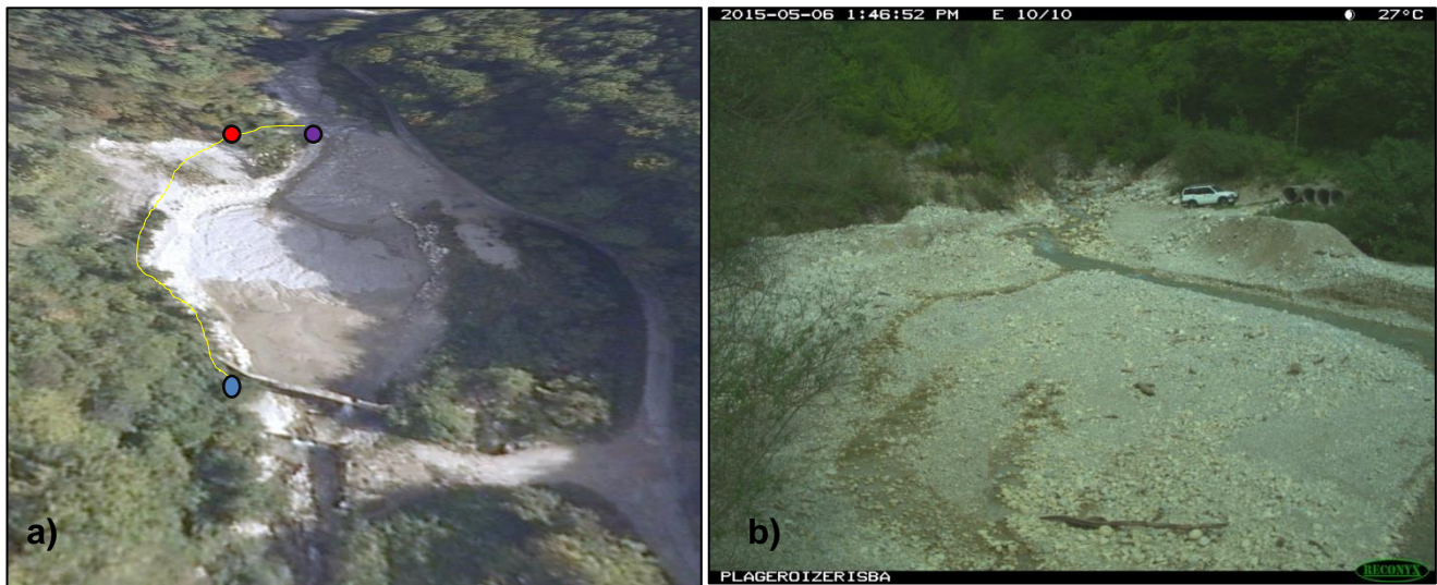
Figure 68 : a) Plan du dispositif installé sur la Roize b) photo prise par la caméra (Fontaine 2015) (•En violet : le géophone, en rouge : le conditionneur, en bleu : la station imagerie, en jaune : la câble de transmission)
