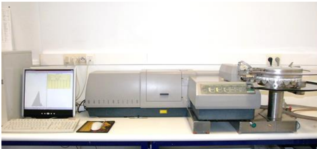
Figure 26 : microgranulomètre à diffraction laser Malvern Mastersizer S
