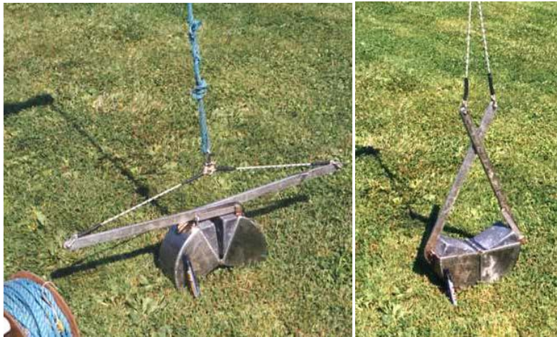
Figure 25 : Benne Van Veen ouverte (à gauche) et fermée (à droite).
