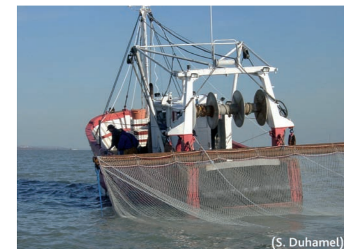
Figure 6. Méthode d'échantillonnage au guideau appliquée dans l'estuaire de la Seine (d'après Morin et al. , 2010)
