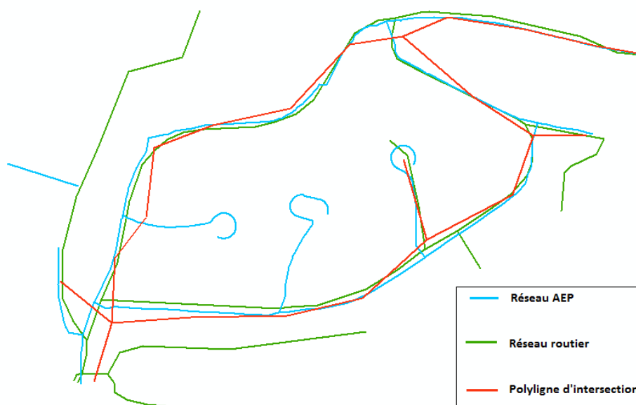
Figure 35: Exemple de lignes obtenues par intersection
