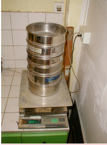
Figure 12 : Tamisage par gravitation.
