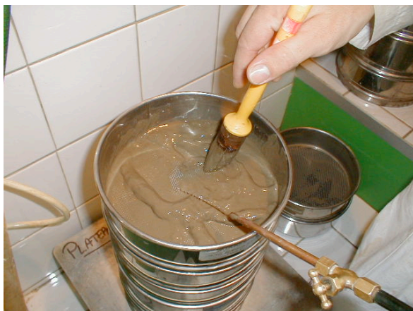
Figure 11 : Jeu de tamis utilisé et bac de récupération.
