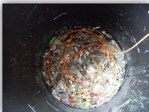
Photo 5 : Enroulement du câble optique dans la colonne
