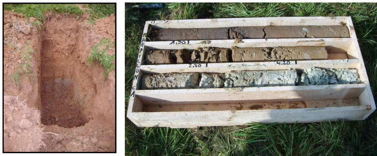
Figure 24 : Fosse à la pelle mécanique et résultats d'un carottage, pendant l'étude géotechnique, sur le bassin versant de Rampillon.
