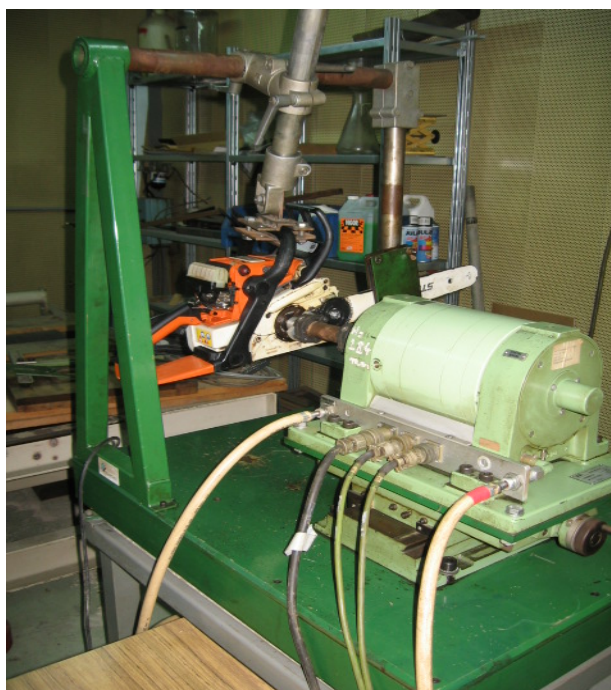
Figure 2 : Schéma de principe du banc d'essai tronçonneuse (à gauche) et photo d'une tronçonneuse accouplée au banc frein
