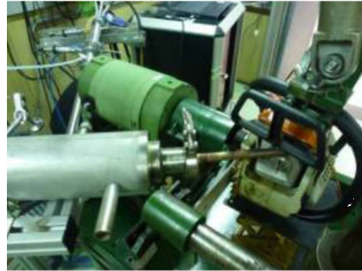
Figure 4 : Schéma du tube de prélèvement et de maintien des conditions de l'effluent réalisé à l'INERIS dans le cadre du projet
