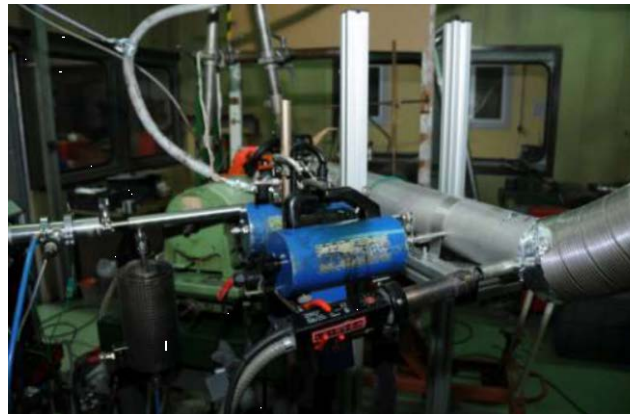
Figure 5 : Photos du tube de prélèvement et de maintien des conditions de l'effluent réalisé à l'INERIS dans le cadre du projet
