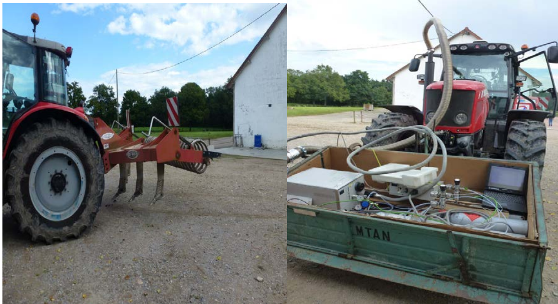
Figure 61 : Equipement du tracteur pendant la campagne d'acquisition sur site : l'outil utilisé sur parcelle est un décompacteur (à droite) et le matériel de mesure des émissions polluantes est installée dans une benne attelée à l'avant du tracteur (à gauche)
