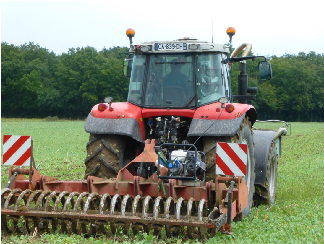
Figure 62 : Opération de décompactage du sol sur la parcelle des palaquins- jour 2
