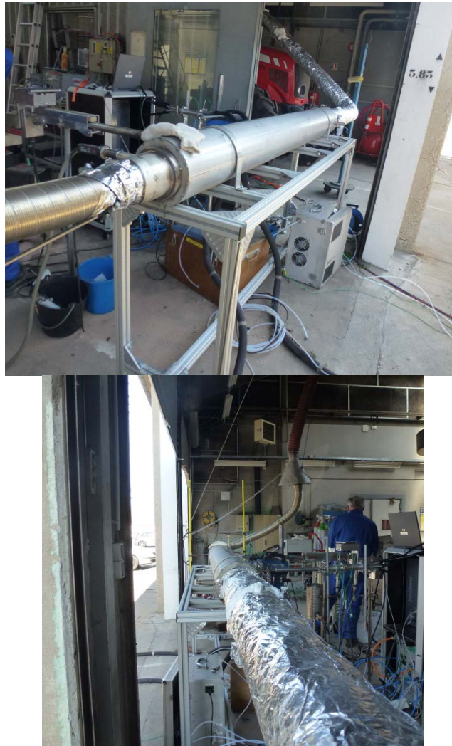
Figure 39 : Gaine de prélèvement des gaz d'échappement
