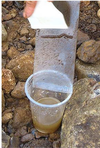
Figure 12: Récupération du biofilm par grattage du substrat artificiel.
