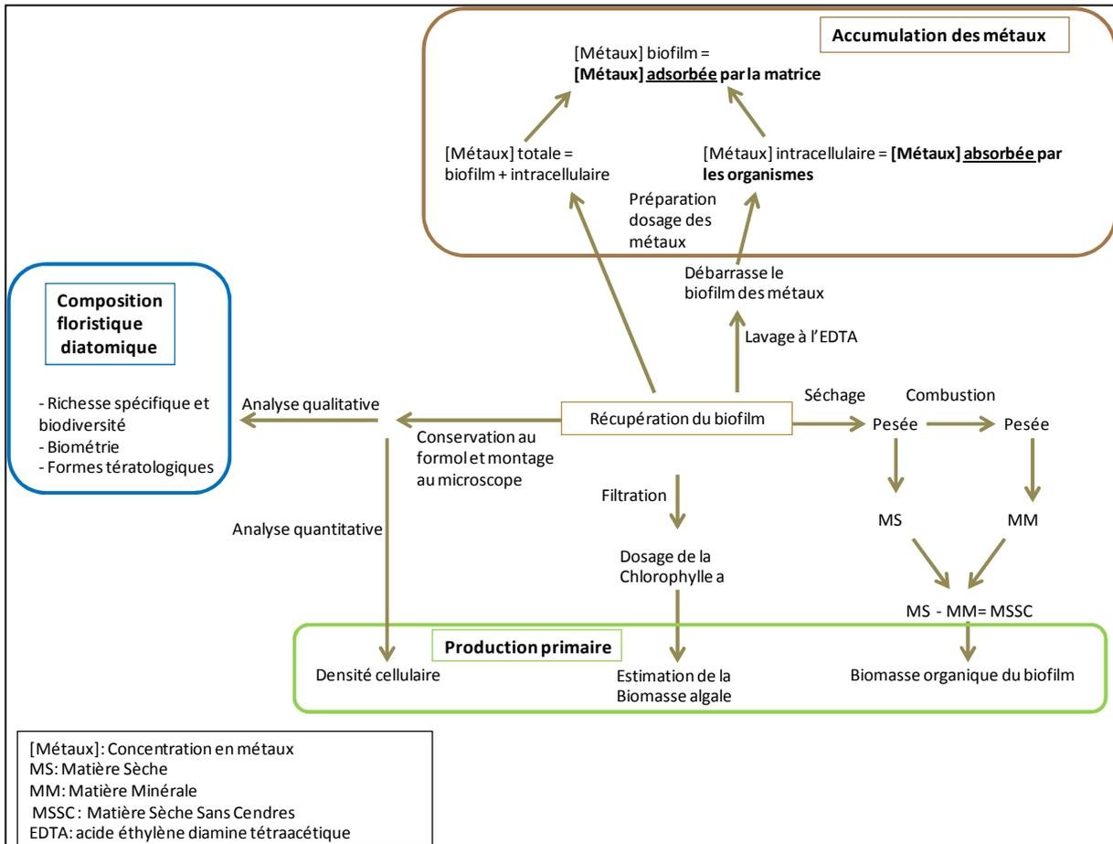
Figure 12: Protocole simplifié de la détection de l'impact des métaux sur le biofilm.
