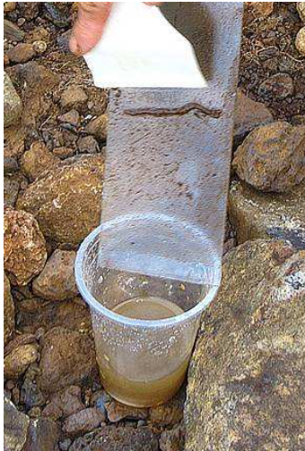
Figure 13: Récupération du biofilm par grattage du substrat artificiel
