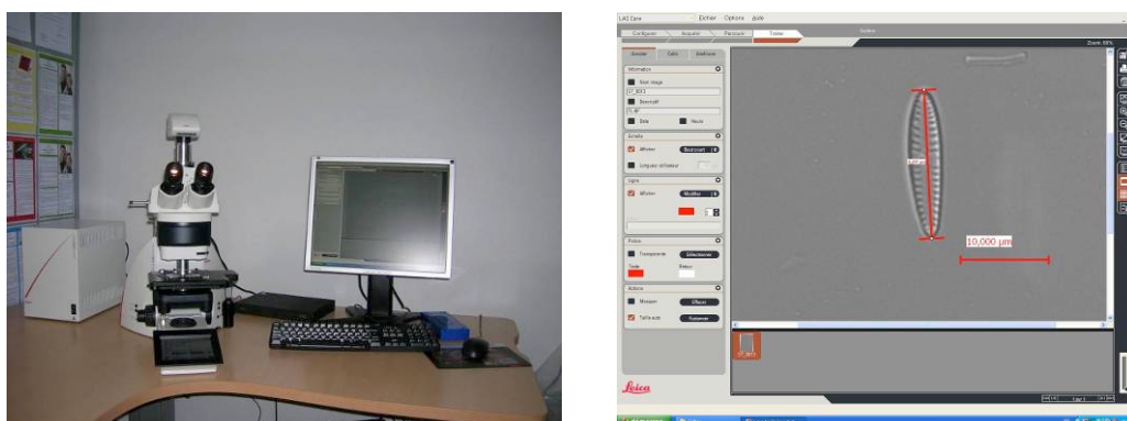
Figure 6 : Microscope et logiciel de capture d'image et de mesures
