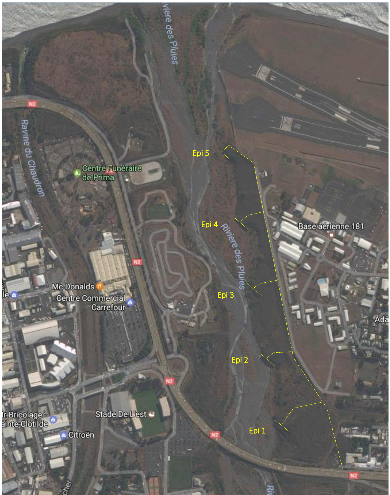
Carte 1 : Localisation des ouvrages – la digue longitudinale et ses 5 épis en pointillés jaune (Source : Maps)
