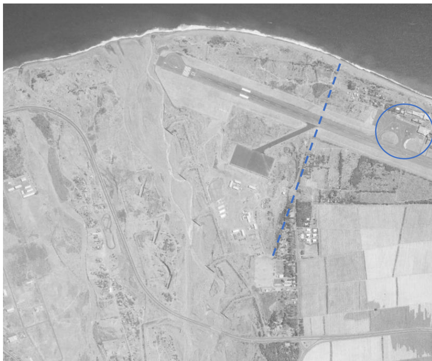
Vue aérienne du 08/11/1973 : la piste de l'aéroport allongée (repères en bleu). Les aménagements sont terminés. La digue RD et ses 5 épis sont nettement visibles. De la végétation est déjà perceptible sur les talus de la digue et des épis (Cf. zoom sur photo suivante).
