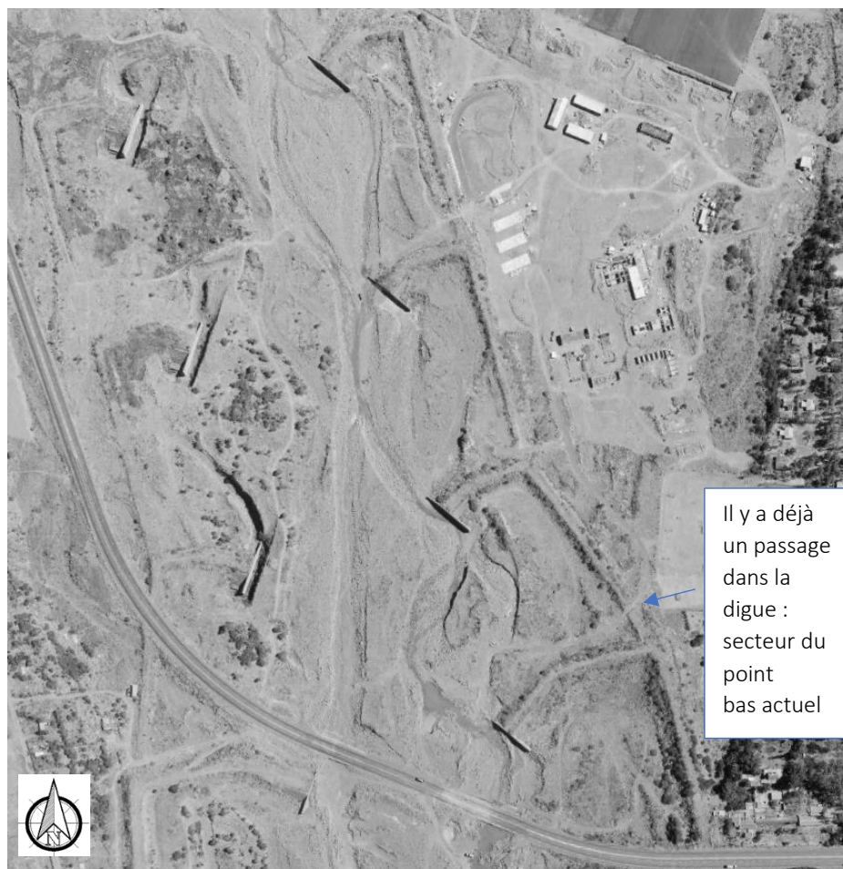
Vue aérienne du 23/10/1973 : Zoom sur les ouvrages avec les 4 premiers épis en RD. Les gabions neufs sont bien visibles.
