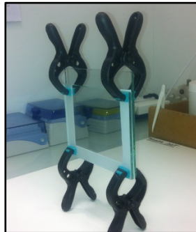
Figure 9 : Moule utilisé pour la fabrication des gels diffusif et des résines Titane
