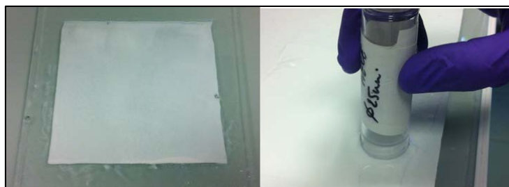
Figure 10 : Découpe des résines à l'aide d'un emporte-pièce
