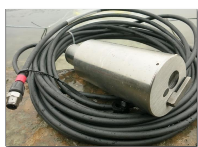
Enregistrement en continu de la turbidité [3] et prélèvements d'eau pour l'analyse des MES
