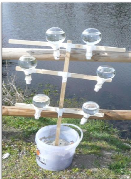
Figure 2 : Dispositif d'immersion des photoréacteurs en quartz de 500 mL à -10, -30 et -50 cm de profondeur : 3x eau déminéralisée (droite), 3x eau de ZRV (gauche)
