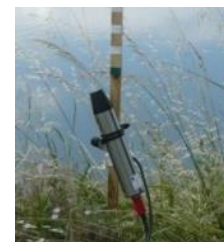
Figure 8 : Spectroradiomètre immergeable (RAMSES, TriOS Optical Sensors) mesurant l'intensité lumineuse transmise
