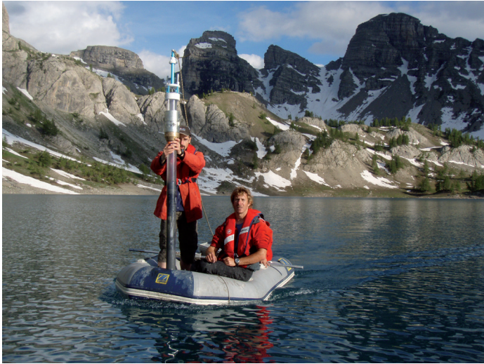
Photo 4. Prélèvement par carottage des sédiments présents au fond du Lac d'Allos (juin 2009). L'étude de cette carotte de sédiments a permis de reconstituer plus d'un millénaire d'activité de crues torrentielles
