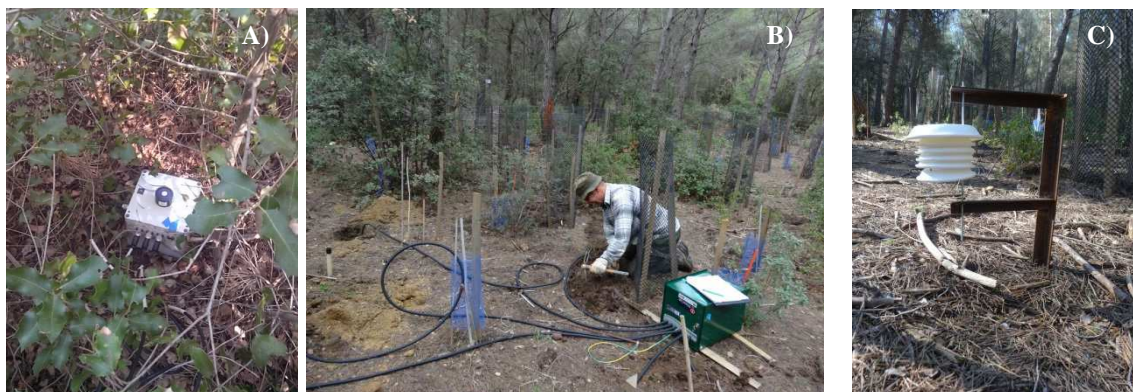
Photos 14. Mesure des facteurs de l'environnement. A) Capteur de lumière PAR, B) Installation de sondes d'humidité du sol, C) Abri pour sonde de température et humidité de l'air. (Photos JM Lopez et J Gavinet)
