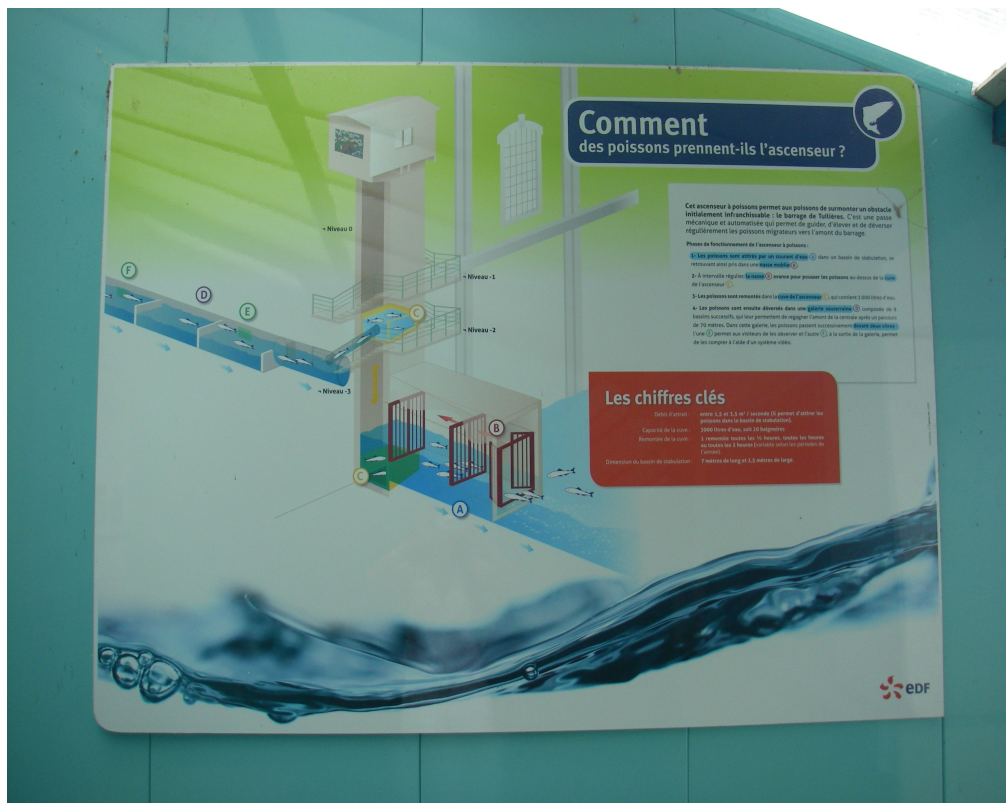
Illustration 13 L'ascenseur d'EDF du barrage de Tuilières sur la Dordogne expliqué aux visiteurs. (Source, panneau d'information du barrage)
