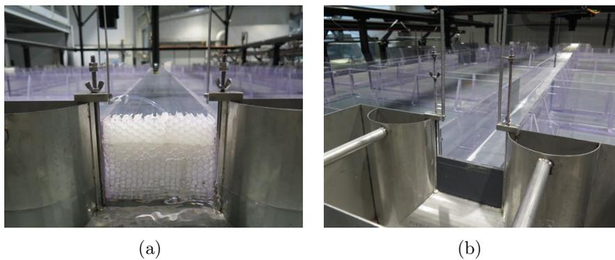
FIGURE 34 – Nid d'abeille en sortie des cuves d'alimentation et tuyau d'ensemencement (a) et seuil réglable en sortie des rues pour contrôler le niveau d'eau (b).
