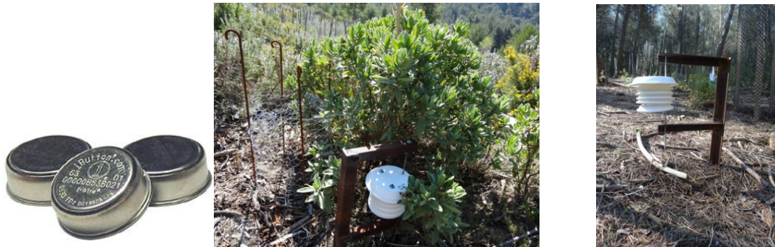
Photographie 5. Capteurs iButton – Hygrocron (Maxim) et abris ventilés pour capteur d'humidité relative et température de l'air (Saint-Mitre)
