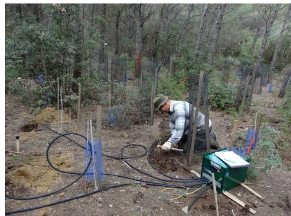
Photographie 6. Installation à -30 cm de profondeur des sondes (EC-5, Decagon Device) de mesure de la teneur en eau volumique du sol sous forêt. Les sondes sont ensuite reliées à la centrale d'acquisition (Site de Saint-Mitre).
