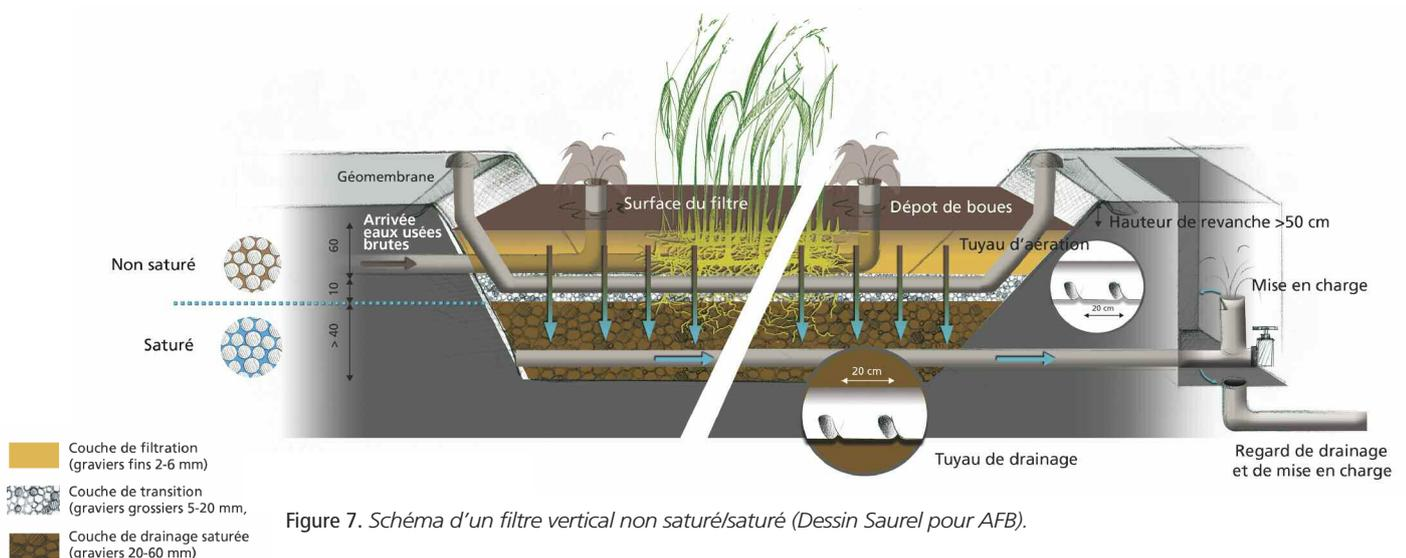
Figure 7. Schéma d'un filtre vertical non saturé/saturé (Dessin Saurel pour AFB).
