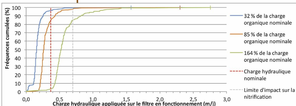
Figure 12. Distribution des charges hydrauliques appliquées sur les filtres de la station de Taupinière (Martinique) entre le 1/01/2015 et le 31/05/2017. Les barres correspondent aux valeurs maximales enregistrées pour chaque série.
