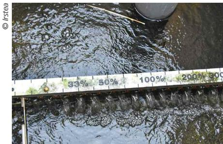
Figure 6. Lame crénelée pour recirculation manuelle.
