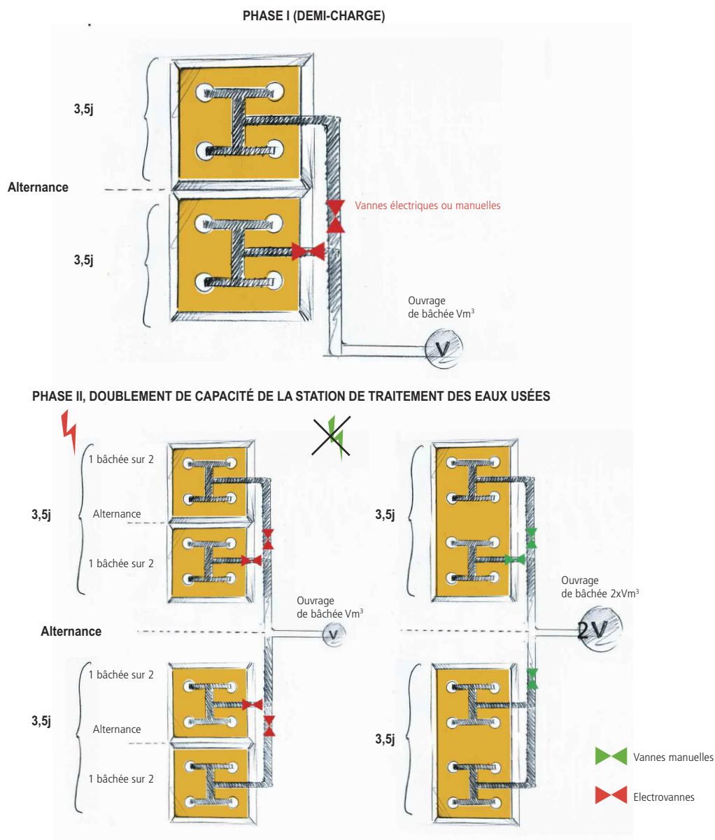
Figure 18. Phasage d'un projet de filtre planté de végétaux (FPV) par partitionnement ou ajout d'une nouvelle file eau.
