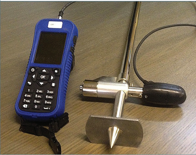
FIGURE 4.6 : UN MODÈLE DE COURANTOMÈTRE ÉLECTROMAGNÉTIQUE (MF PRO DE OTT) : CAPTEUR ET BOÎTIER
