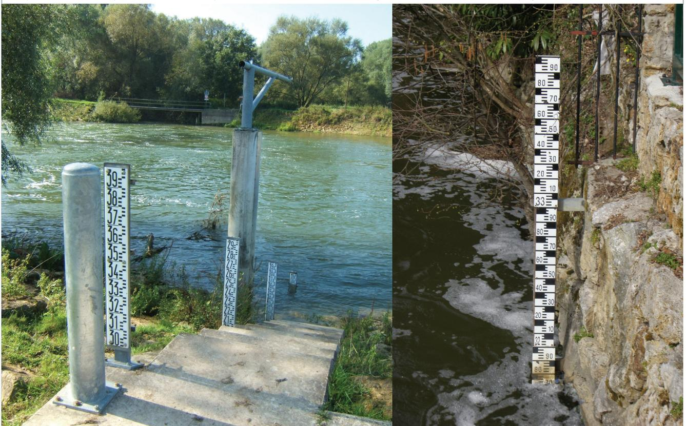
À gauche : La potence sert de support à un radar hors d'eau en crue qui mesure aussi la hauteur d'eau en étiage. Un escalier d'accès maçonné dans les enrochements permet un accès facile et sûr pour les jaugeages et le nettoyage des échelles. Des échelles déportées permettent une lecture en crues. Le coffret de la station est hors d'eau, à environ 100 m (non visible sur la photo). La transmission est réalisée par câble enterré.
