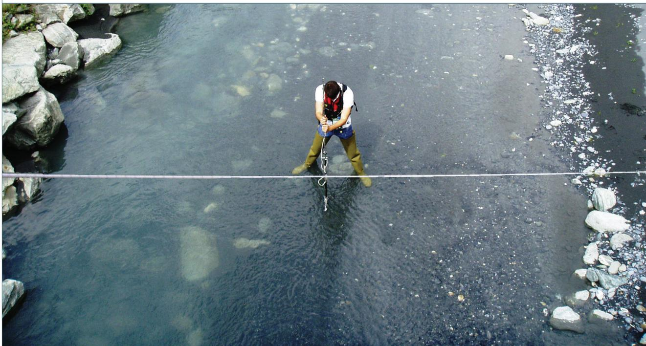
Le jaugeur est positionné face au courant, légèrement en aval de la section de mesure pour ne pas perturber les vitesses mesurées, la perche est devant lui et orientée vers l'amont perpendiculairement à la section et non en fonction des lignes de courant préférentielles si elles ne sont pas perpendiculaires au transect.
