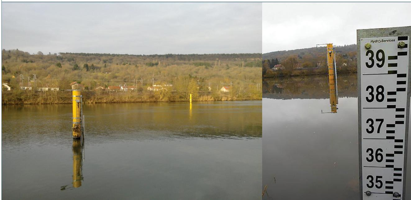
La rivière est navigable. Une échelle déportée est présente en complément de celle posée sur le pieu. Certains détails ne sont pas visibles sur la photo : la potence du radar de mesure vers l'amont, le boîtier électrique de connexion hors d'eau entre les câbles de transfert vers la station et les sondes, le chariot pour remonter les sondes, l'échelle qui va permettre de travailler sur le pieu et la sonde piézo-résistive de secours.
