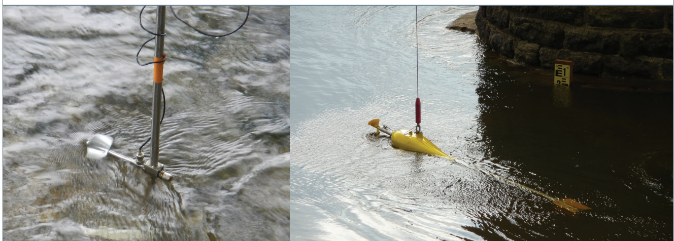
FIGURE 4.5 : MONTAGE D'UN MOULINET SUR PERCHE À GAUCHE ET SUR SAUMON À DROITE (DREAL NORMANDIE, DREAL CENTRE VAL DE LOIRE)
