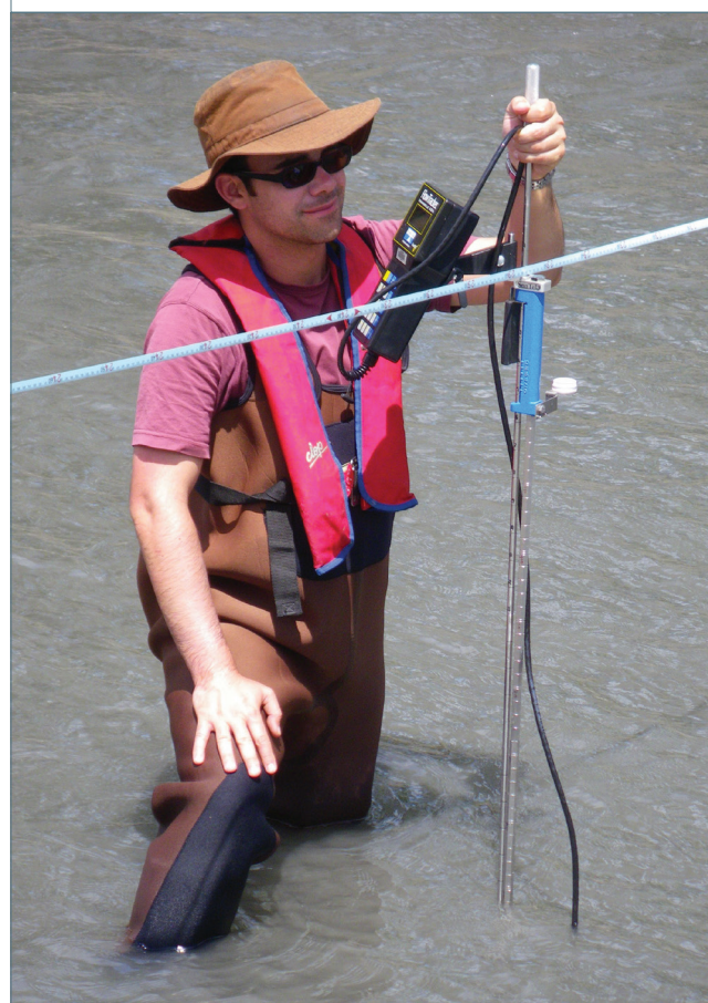
« JAUAGE AVEC UN COURANTOMÈTRE ACOUSTIQUE SUR L'ARC EN MAURIENNE (73) » (IRSTEA)
