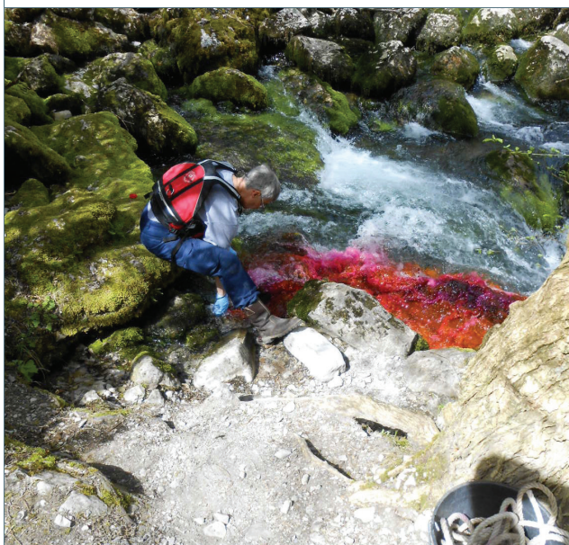
FIGURE 4.13 : À GAUCHE : INJECTION INSTANTANÉE DU TRACEUR RHODAMINE WT ; À DROITE : ENREGISTREMENT DE LA CONCENTRATION AU COURS DES DIFFÉRENTES PHASES DE LA MESURE (AJUSTAGE DES FLUORIMÈTRES, MESURE DU BRUIT DE FOND ET PASSAGE DU NUAGE D'INJECTION), (EDF-DTG)
