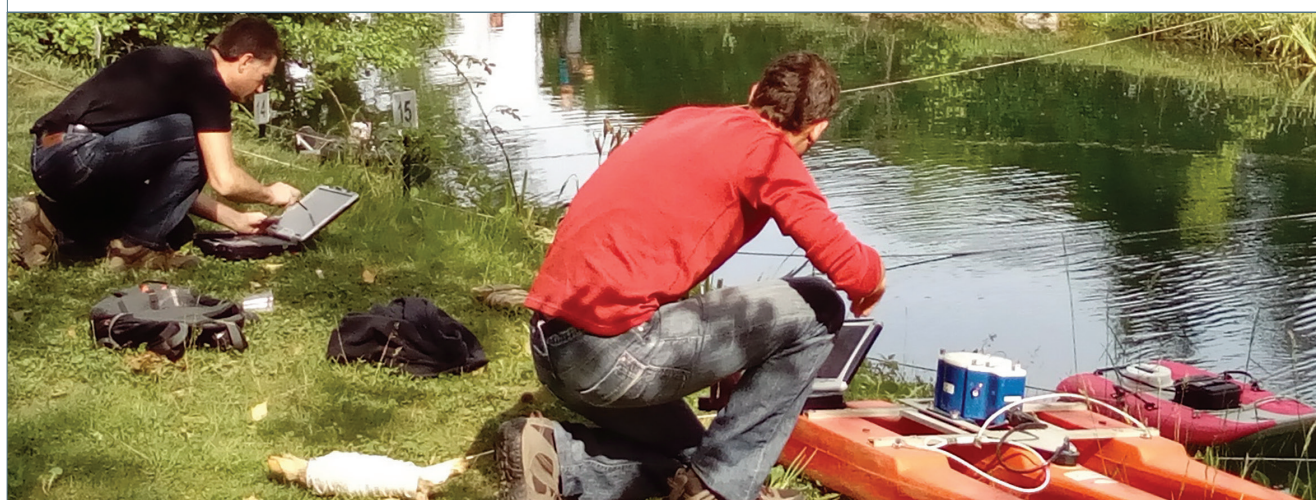
JAUGEAGE À L'ADCP (DREAL AUVERGNE-RHÔNE-ALPES)
