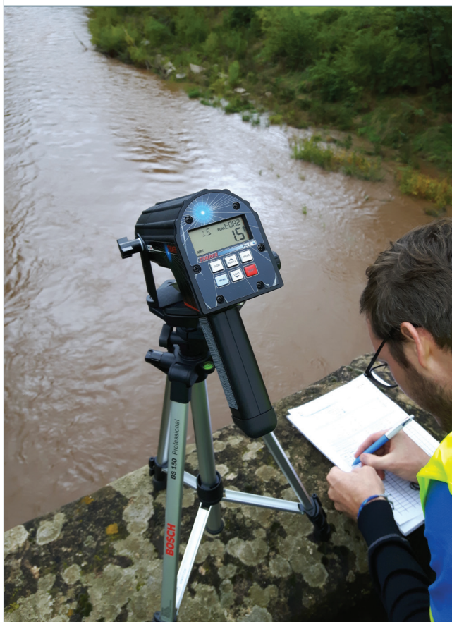
FIGURE 4.12 : DEUX TYPES DE RADAR DE SURFACE : LE SVR STALKER PRO II (EDF) ET LE SVR (DECATUR) (IRSTEA)
