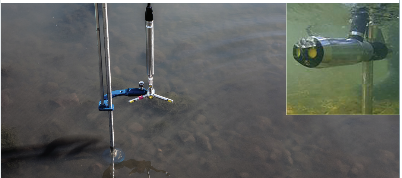
FIGURE 4.7 : DEUX MODÈLES DE COURANTOMÈTRES ACOUSTIQUES (FLOWTRACKER DE SONTEK ET ADC DE OTT)
