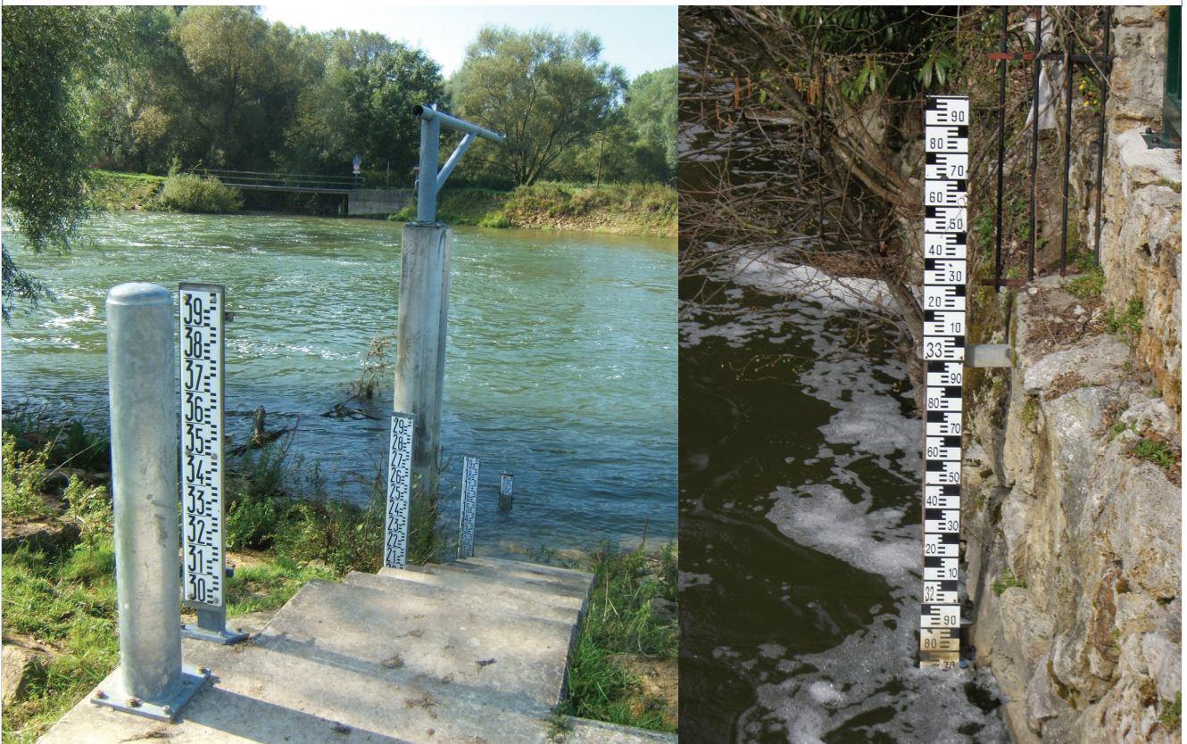
FIGURE 3.1 : À GAUCHE : STATION HYDROMÉTRIQUE À RELATION HAUTEUR-DÉBIT EN SECTION COURANTE, LA MEUSE À STENAY, 3 904 KM 2 (DREAL GRAND-EST, UH MEUSE MOSELLE). À DROITE : ÉCHELLE LIMNIMÉTRIQUE SUR L'YERRES À CROSNES (AQUI' BRIE).
