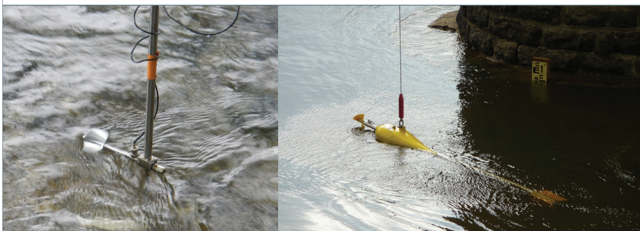
FIGURE 4.5 : MONTAGE D'UN MOULINET SUR PERCHE À GAUCHE ET SUR SAUMON À DROITE (DREAL NORMANDIE, DREAL CENTRE VAL DE LOIRE)
