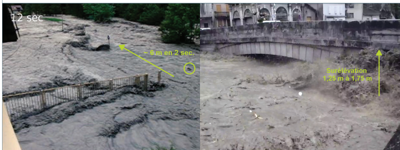
À gauche : parcours d'un objet flottant ; à droite : surélévation fournissant une évaluation du terme V^2/2g ( 1.25 < V^2/2g < 1.75 m, soit 5 < V < 5.9 m/s)
