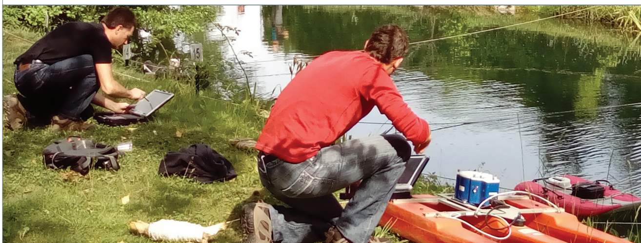
JAUGEAGE À L'ADCP (DREAL AUVERGNE-RHÔNE-ALPES)
