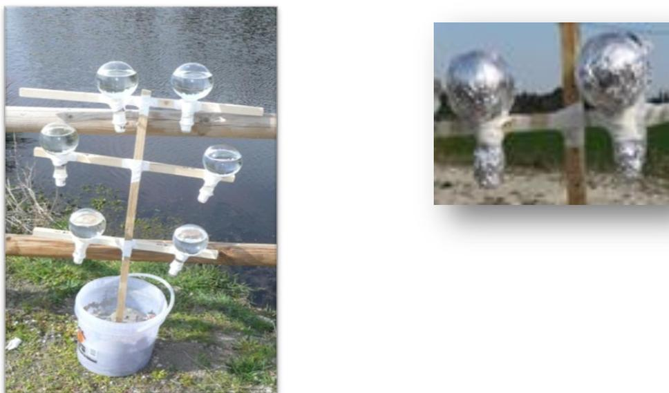
*Figure 4 : Dispositif d'immersion des photoréacteurs en quartz de 500 mL à -10, -30 et -50 cm de profondeur : 3x eau déminéralisée (droite), 3x eau de ZRV (à gauche) et Photoréacteurs « témoins » recouverts d'aluminium et immergés à -10 cm de profondeur (à droite)*
