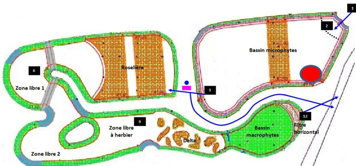
Figure 3 : Schéma de la ZRV de type bassin et localisation (en rouge) des photoréacteurs immergés dans le bassin (point rouge), l'entrée de la ZRV correspond au point 1 et la sortie au point 12.
