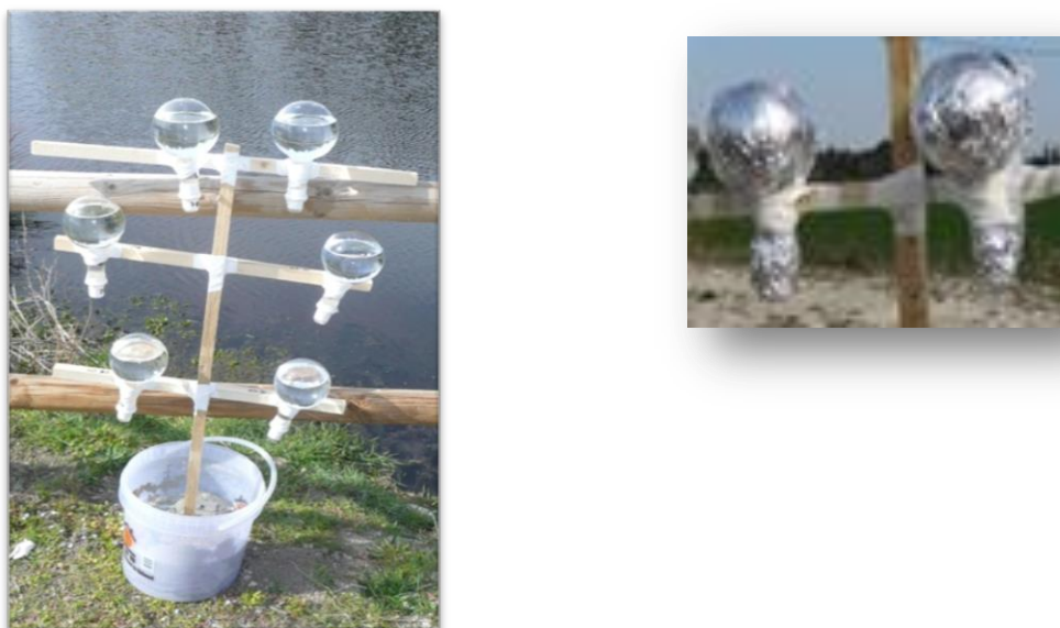
Figure 4 : Dispositif d'immersion des photoréacteurs en quartz de 500 mL à -10, -30 et -50 cm de profondeur : 3x eau déminéralisée (droite), 3x eau de ZRV (à gauche) et Photoréacteurs « témoins » recouverts d'aluminium et immergés à -10 cm de profondeur (à droite)
