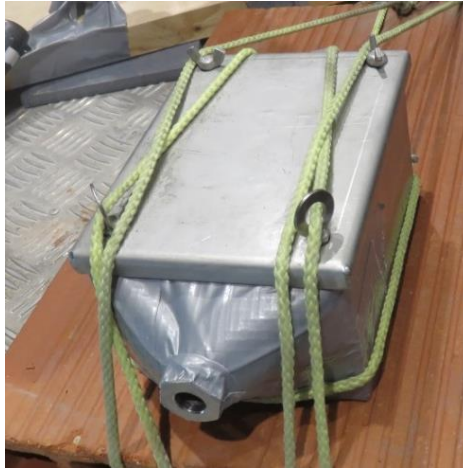
Figure 19 Piège à particules miniature fixé sur une brique constituant la berge, avec un déflecteur installé sur la face orientée vers l'amont du canal.
