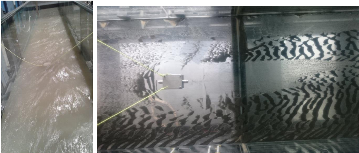
Figure 10 Installation de piège réduit dans le canal, à gauche : photo du piège vue de dessus, à droite, vue de dessous à travers le fond du canal.
