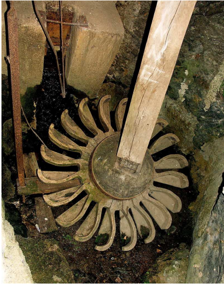
FIGURE 2.3 – Photo du rodet du moulin de Nougayrol à Castanet-le-Haut (Hérault) (Crédit : Castanet, licence : CC BY-SA 3.0)
